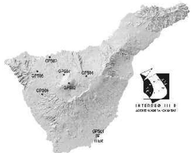
Red GPS permanente para la vigilancia volcánica de Tenerife
